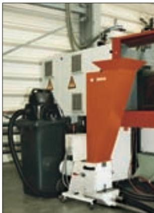
◀ C 13.20 s Wanner con tramoggia per manipolatore, impianto di trasporto in depressione con bidone per raccolta del materiale, tramoggia per aspirazione con due collegamenti.
