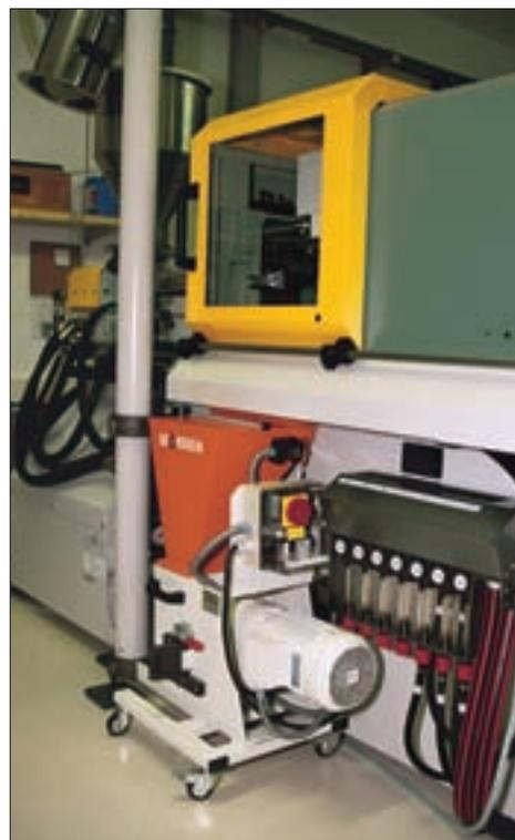
Wanner C17.26 s con tramoggia speciale per macchina per stampaggio a iniezione ERGOtech pro (Viva) con manipolatore integrato (nella figura 80 to).
